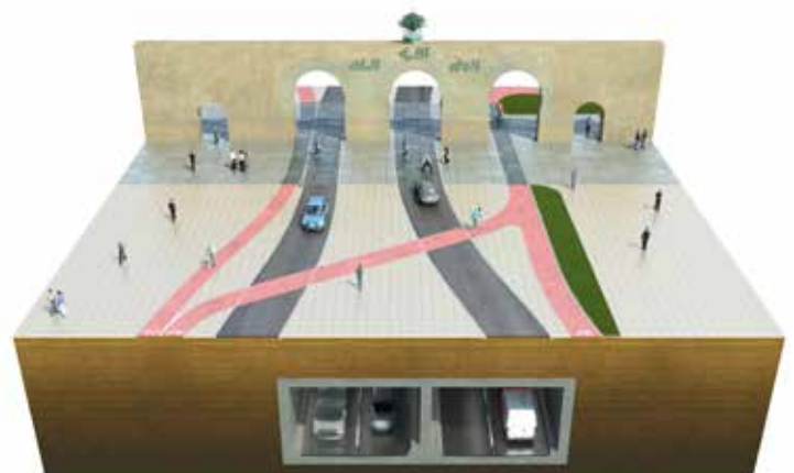
Perfil transversal tipo — Zona do aqueduto
