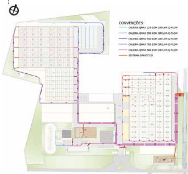
PLANTA DA REDE DE ÁGUAS PLUVIAIS
