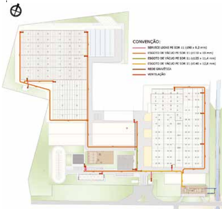
PLANTA DA REDE DE ÁGUAS RESIDUAIS DOMÉSTICAS
